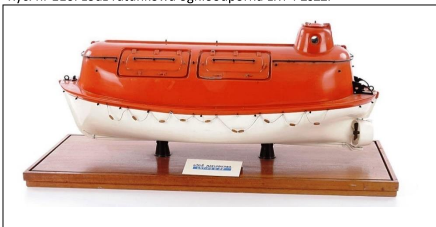
Ryc. nr 116. Łódź ratunkowa ognioodporna ŁRT-P2sZZ.
