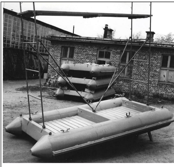
Ryc. 84. Pływaki aluminiowe do malowania burt statków.
