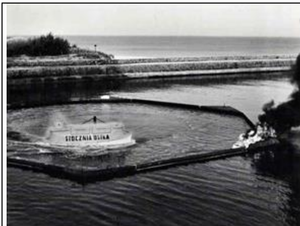
Ryc. nr 72. Łódź na początku próby ogniowej.
