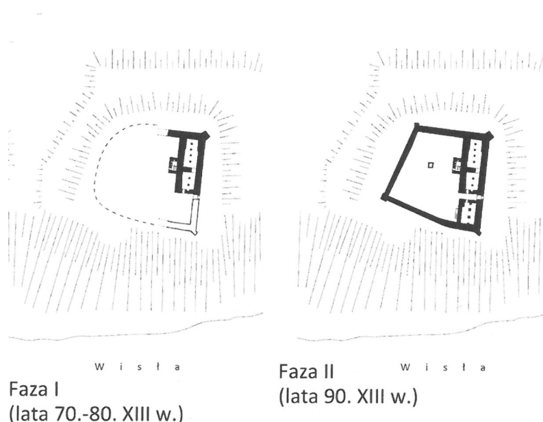
Ryc. 67 Grudziądz- próba rekonstrukcji I- II fazy budowy zamku (oprac. B. Wasik na podstawie wyników badań archeologiczno- architektonicznych oraz nowożytnej ikonografii i ilustracji) 87
