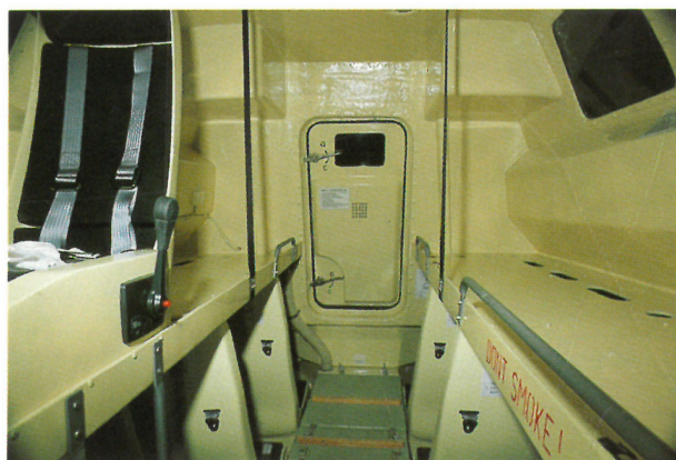
Duże drzwi do szybkiej ewakuacji załogi.
