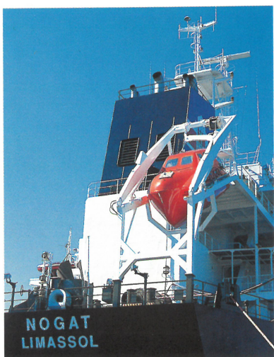
Łódź ratunkowa swobodnego spadania na urządzeniu zrzutowym z żurawikiem hydraulicznym – widok z przodu.
