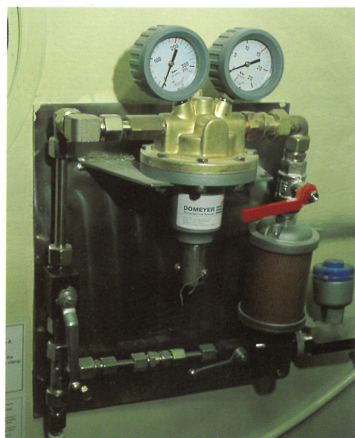
Regulator ciśnienia z zaworami bezpieczeństwa w łodzi ognioodpornej.
